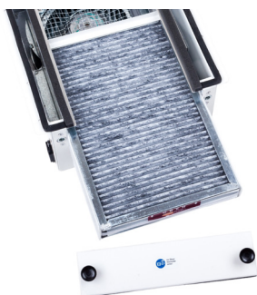
Immagine n. 3 Vista del sistema di raccolta della polvere dei chiodi con l'elemento filtrante principale estratto e i motori sottostanti
